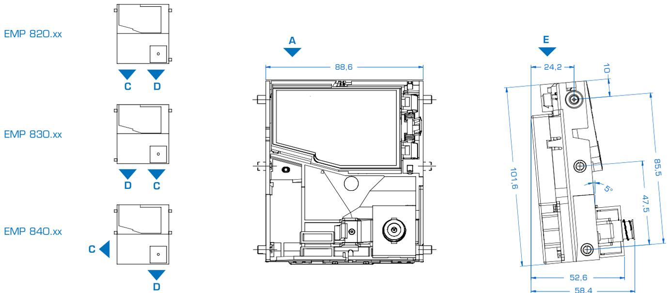
EMP 8x0.xx für Rahmenmontage, Ausführung mit totaler Öffnung (Klappe und Weichenplatte öffnen sich)
