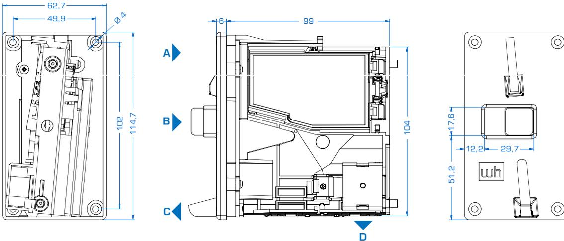
**EMP 850.xx mit Stahl-Frontplatte F 801 117 x 60 mm**
